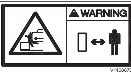
39 WAARSCHUWING! Gevaar voor beknelling. Werkbereik van de graafmachine niet betreden.
